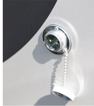
車両右側面にございます。コンセントは爪が入るまでしっかり挿し込んでください。車内に専用のコードがあるので、専用コードをご使用ください。
